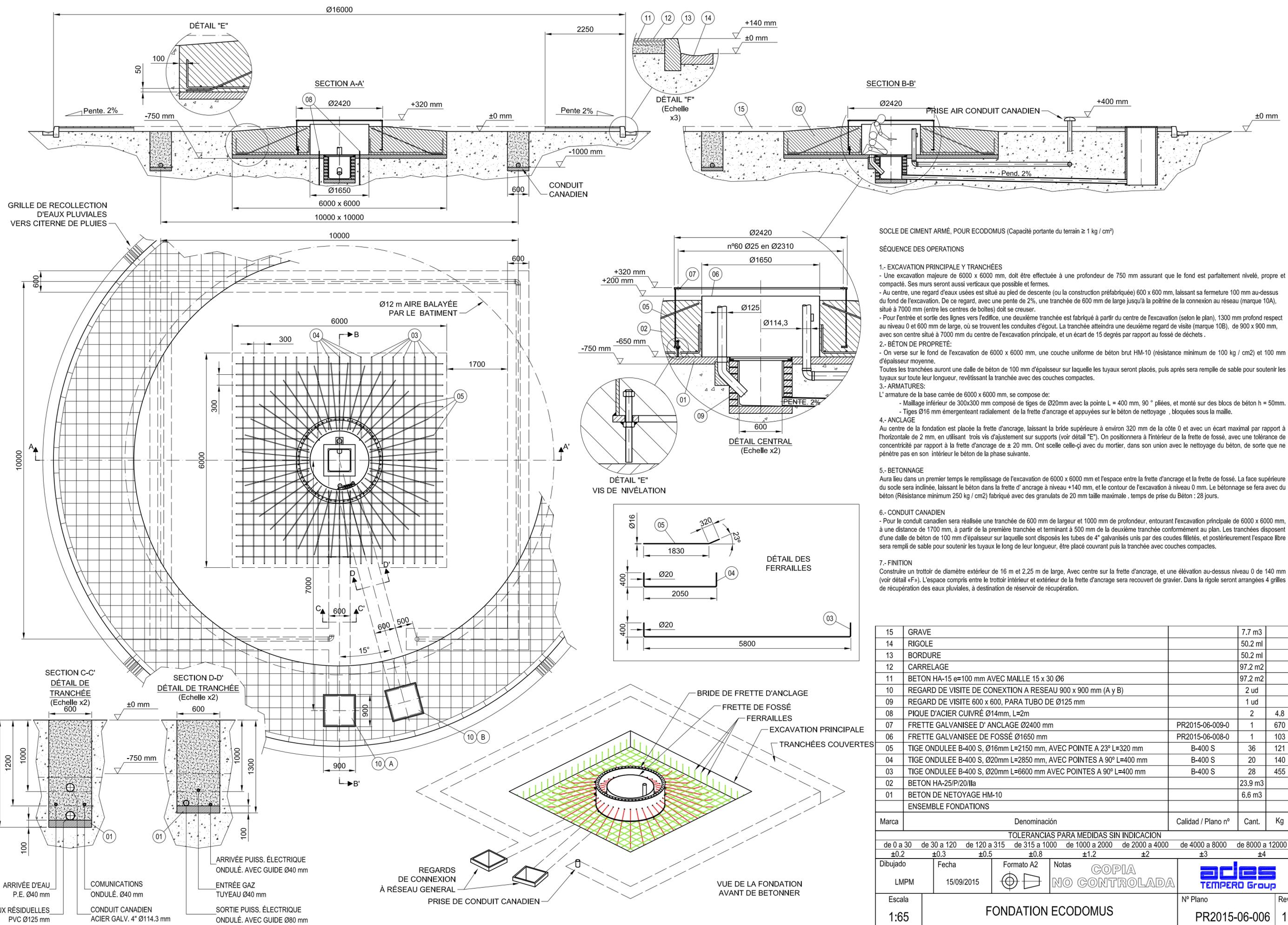
SOCLE DE CIMENT ARMÉ, POUR ECODOMUS (Capacité portante du terrain  $\geq 1 \text{ kg/cm}^2$ )
